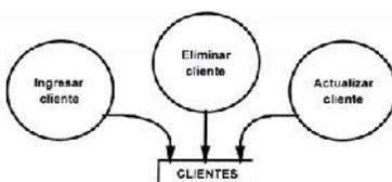
Figura 9.12 – Ejemplo de flujos de datos hacia un depósito de datos.
